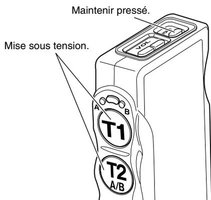
3. Appuyer sur le bouton T1 pour que le preneur de commande recherche le module central. On entend alors "Connecting center module A" et l'indicateur de passage clignote en jaune.
