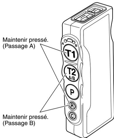
Quand on souhaite enregistrer le gérant dans un autre module central dans un environnement de système double de service clientèle de passage, tout en maintenant R et T2 enfoncés simultanément, appuyer sur le bouton d'alimentation pour mettre en marche le preneur de commande. Il est possible d'entendre "Connecting center module B" et le témoin d'alimentation clignote alternativement du rouge au vert. En outre, l'indicateur de passage B clignote au vert.
