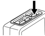
2. Quand PASSAGE A est réglé en mode de gérant, continuer à appuyer sur les boutons R et T1 simultanément et mettre en marche le preneur de commande.
